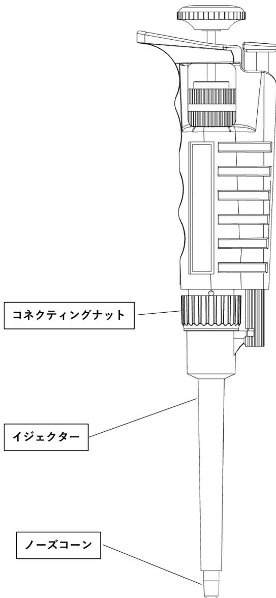
左図のイジェクターを外した後、コネクティングナットと、ノーズコーンを外すと、下図のピストン部位が取り出せます。
