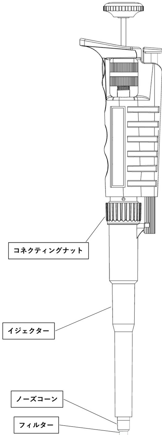
左図のイジェクターを外した後、コネクティングナットと、ノーズコーンを外すと、下図のピストン部位が取り出せます。
